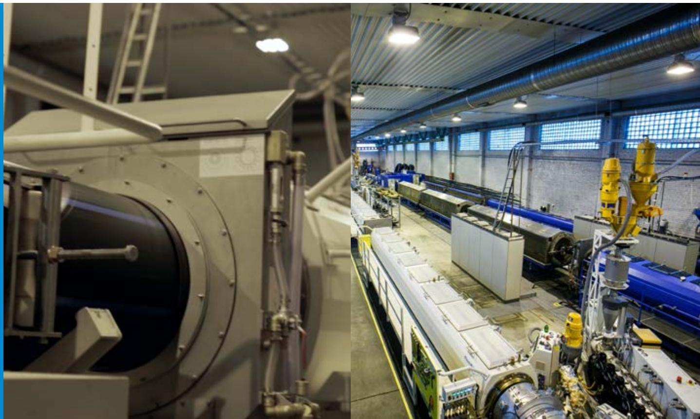
Проходя через вакуумную ванну калибровки и охлаждения, труба приобретает нужный диаметр и охлаждается. Труба проходит систему воздушного охлаждения внутренней поверхности трубы, что позволяет равномерно охлаждать стенку трубы, избегая градиента температур, а, следовательно, и возникновения внутренних напряжений в стенке трубы.
