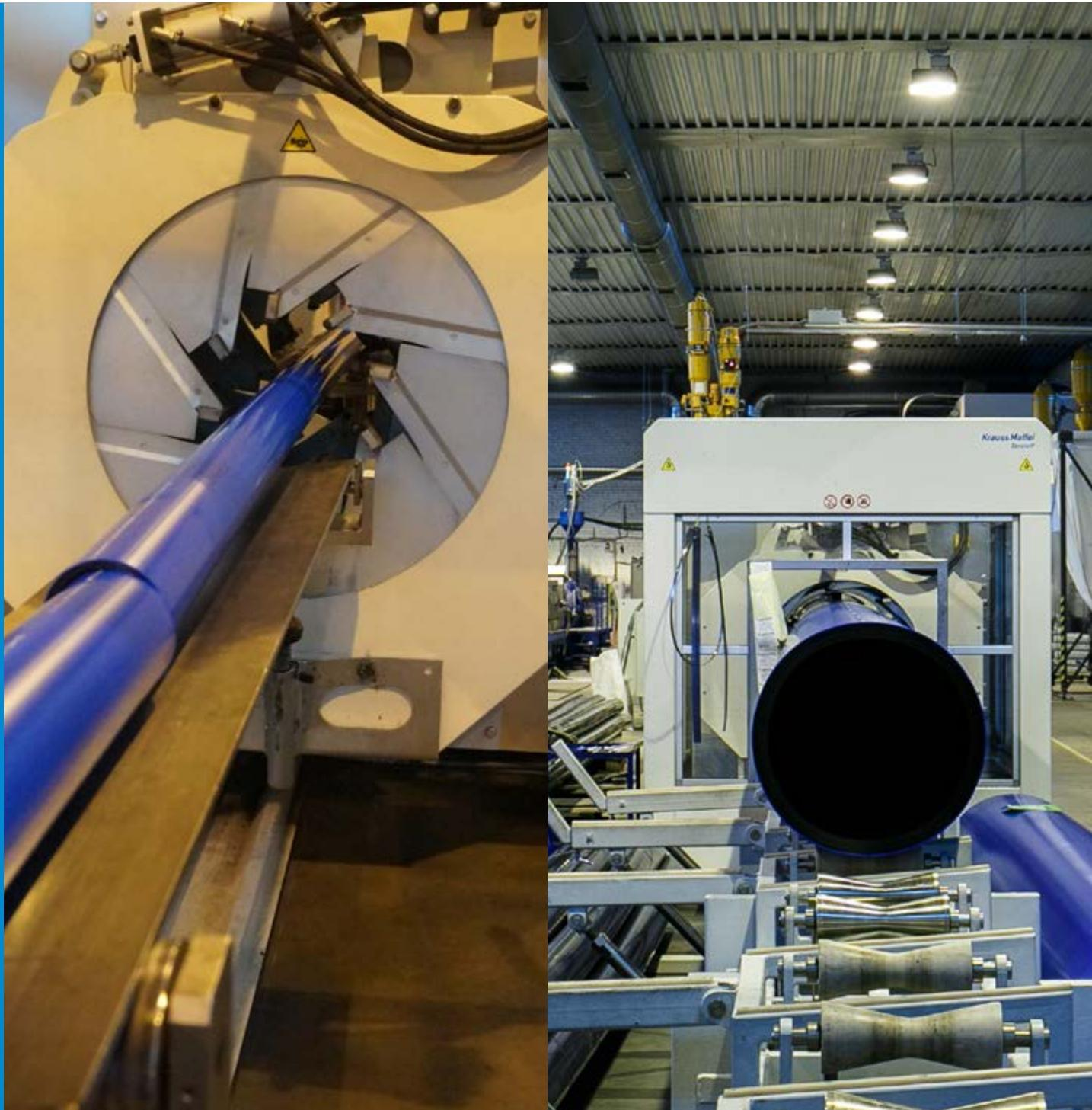
Резка труб осуществляется специальным ножом. Машина этого типа осуществляет резку без удаления материала, не оставляя стружки и пыли, а также обладает низким уровнем шума.
