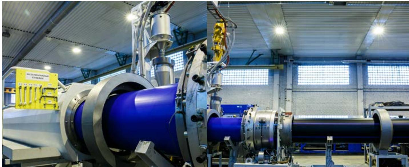
Защитное покрытие (jacket) наносится на трубы соэкструзией с помощью специальной покрывной головки. Защитное покрытие легко удаляется при монтаже. Защитный слой изготовлен из композиции полипропилена с минеральным наполнителем. Защитный слой может быть окрашен по цвету назначения трубы: желтый – для газопроводов, синий – для питьевого водоснабжения.
