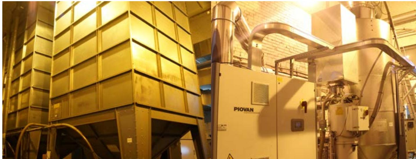
Качественная подготовка поступающего на завод сырья обеспечивается эффективной системой сушки. Гранулы засыпают в силос, откуда сырье поступает в сушильный бункер для удаления влаги.
