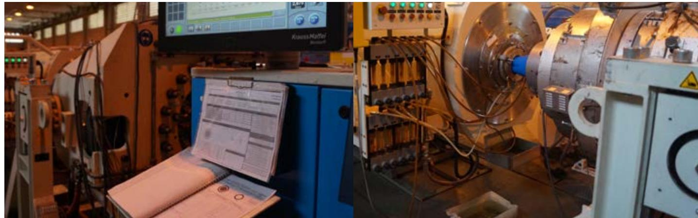
Высушенное сырье поступает в экструдер и разогревается до температуры плавления, затем перемешивается в однородную массу, которая поступает в формующую голову и на выходе приобретает форму трубы.
